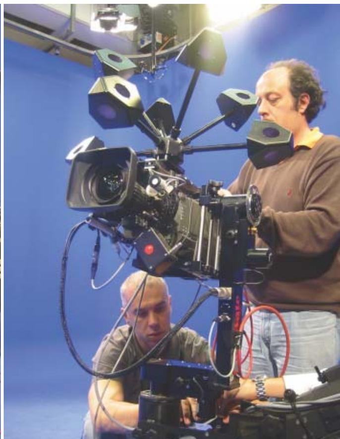
*L'ingombro del sistema di tracking Xinc ha imposto numerose modifiche alla testa pan/tilt* *Una fase della complessa messa a punto della testa pan/tilt*
