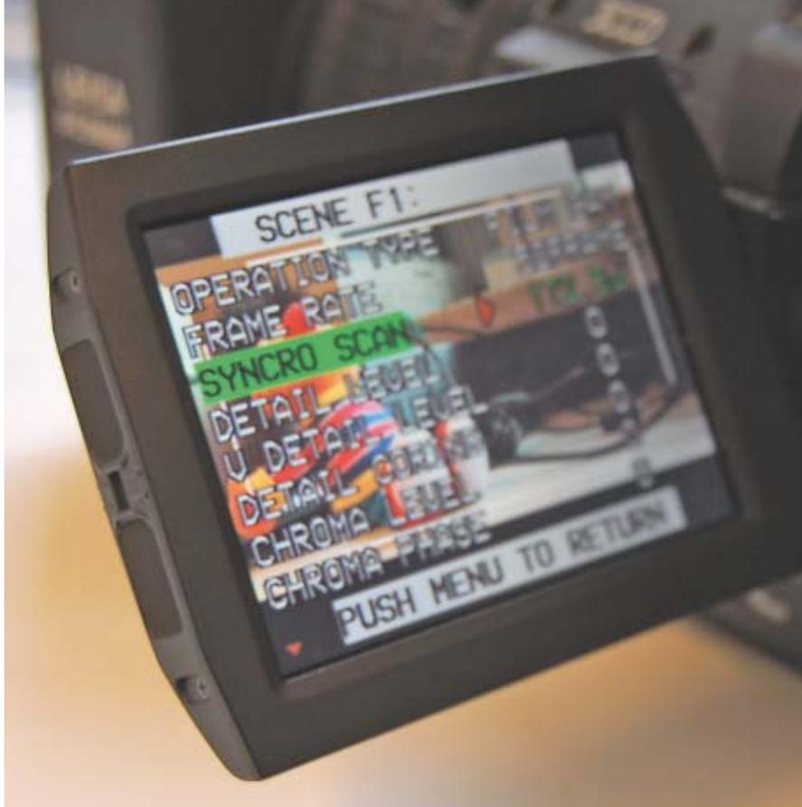
Quando la videocamera è in Film mode, il tempo d'esposizione si regola variando "l'angolo dell'otturatore"
